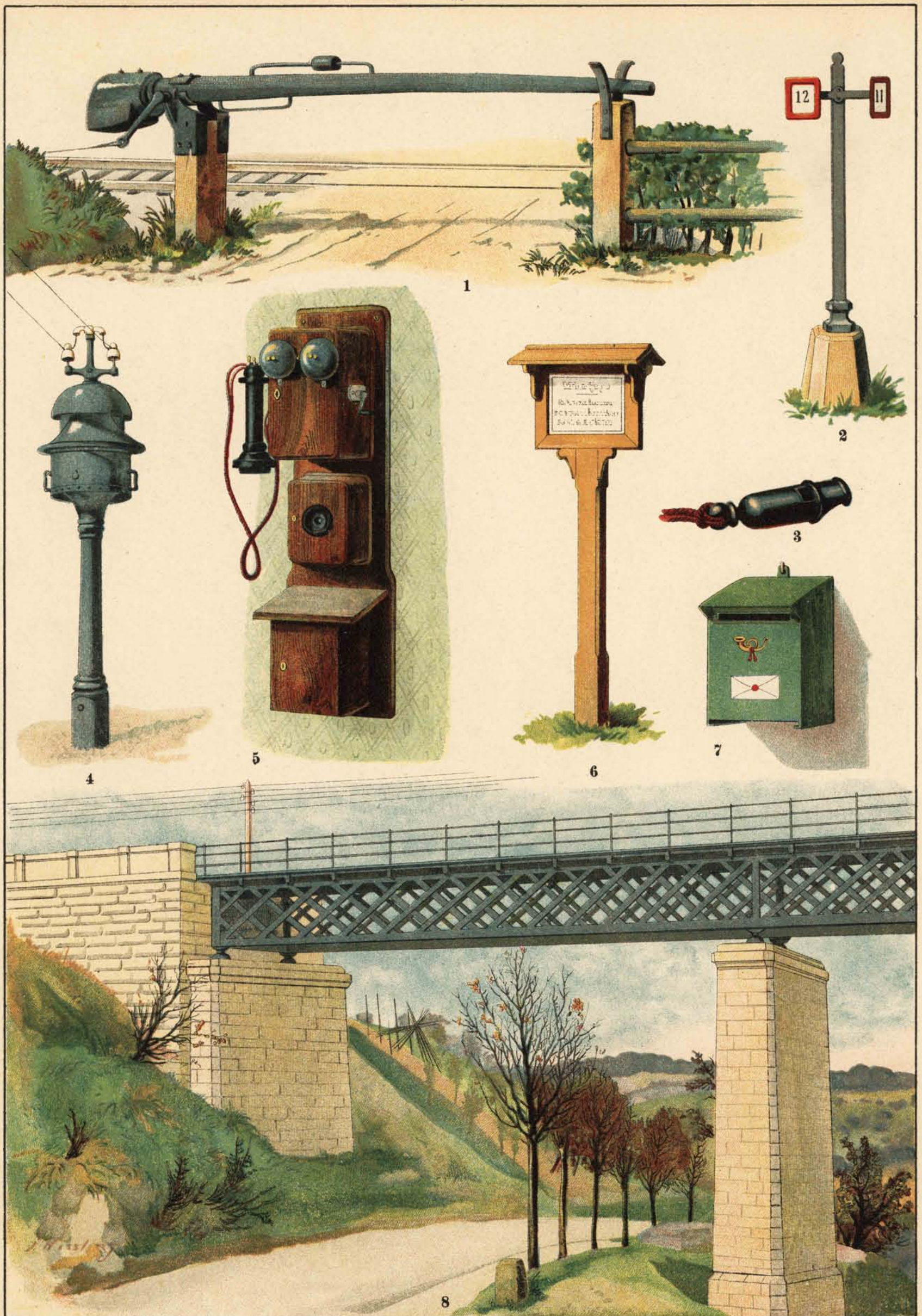
По желѣзной дорогѣ. Б. 1. Шлагбаумъ. — 2. Верстовой столбъ. — 3. Сигнальный свистокъ. — 4. Аппаратъ со звонкомъ. — 5. Телефонъ. — 6. Доска съ правилами для прохожихъ. — 7. Почтовый ящикъ. — 8. Желѣзнодорожный мостъ.
